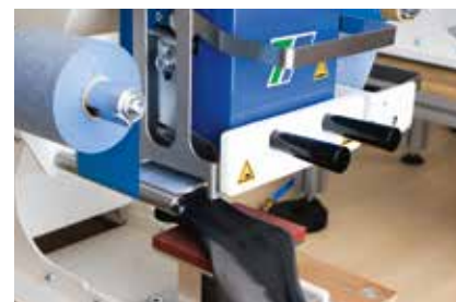
Bedruckung mit Heißsiegelspezialfarbband
